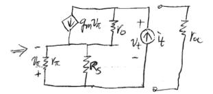
$$i_{\rm t} = g_{\rm m} v_{\pi} + \frac{v_{\rm t} + v_{\pi}}{\gamma_{\rm o}}$$
