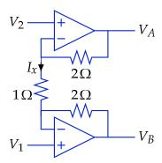
Determine the current  $I_x$  when  $V_1=1\,\mathrm{V}$  and  $V_2=2\,\mathrm{V}.$
