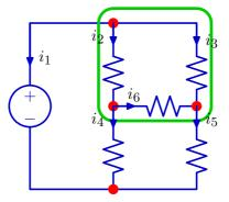
nodes 1+2:  $i_1 + i_3 + i_4 + i_6 = 0$ node 3:  $-i_3 - i_6 + i_5 = 0$ nodes 1+2+3:  $i_1 + i_3 + i_4 + i_6 - i_3 - i_6 + i_5 = i_1 + i_4 + i_5 = 0$
