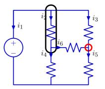
nodes 1+2:  $i_1 + i_2 + i_3 - i_2 + i_4 + i_6 = i_1 + i_3 + i_4 + i_6 = 0$ node 3:  $-i_3 - i_6 + i_5 = 0$
