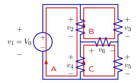
$$A: -v_1 + v_2 + v_4 = 0$$
