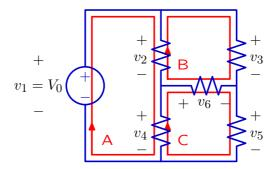
$A: -v_1 + v_2 + v_4 = 0$  $B: -v_2 + v_3 - v_6 = 0$  $C: -v_4 + v_6 + v_5 = 0$
