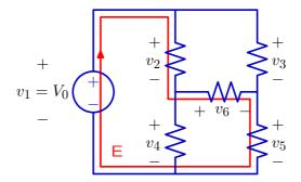
$$\mathsf{E}: -v_1 + v_2 + v_6 + v_5 = 0$$
