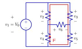
$$\mathsf{F}: -v_4 - v_2 + v_3 + v_5 = 0$$
