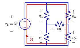
$$G: -v_1 + v_3 + v_5 = 0$$
