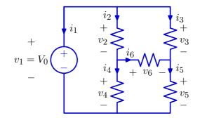
12 unknowns:  $v_1$ ,  $v_2$ ,  $v_3$ ,  $v_4$ ,  $v_5$ ,  $v_6$ ,  $i_1$ ,  $i_2$ ,  $i_3$ ,  $i_4$ ,  $i_5$  and  $i_6$ . 12 equations: 3 KVL + 3 KCL + 5 for resistors + 1 for V source
