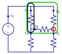
nodes 1+2:  $i_1 + i_3 + i_4 + i_6 = 0$ node 3:  $-i_3 - i_6 + i_5 = 0$ nodes 1+2+3:  $i_1 + i_3 + i_4 + i_6 - i_3 - i_6 + i_5 = i_1 + i_4 + i_5 = 0$
