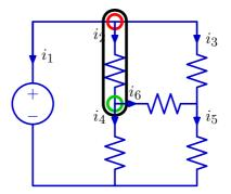
node 1:  $i_1 + i_2 + i_3 = 0$ node 2:  $-i_2 + i_4 + i_6 = 0$ nodes 1+2:  $i_1 + i_2 + i_3 - i_2 + i_4 + i_6 = i_1 + i_3 + i_4 + i_6 = 0$
