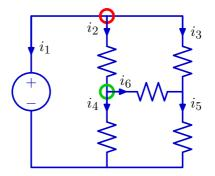
node 1:  $i_1 + i_2 + i_3 = 0$ node 2:  $-i_2 + i_4 + i_6 = 0$
