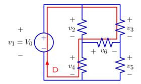
$$\mathsf{D}: -v_1 + v_3 - v_6 + v_4 = 0$$
