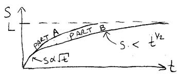
AT EARLY TIMES, THE SOLIDIFICATION FRONT GOES AS  $E^{V_2}$ , JUST AS BEFORE. BUT ONCE HEAT ACCUMULATES IN THE MOLD
