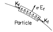
Fig. 10.10.2. Control volume enclosing double layer.
